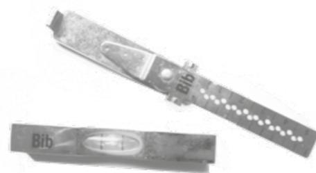
On place la pièce centrale de la photo sur le plateau, réglé à l'horizontale grâce au niveau ; la pièce en pointe se place sur elle, comme un fléau de balance, et a la possibilité d'osciller. La pointe reçoit l'aiguille. On place une petite bille (manquante sur la photo) dans un des trous de l'autre côté du bras pour viser l'équilibre et, à chaque trou, correspond une force d'appui.
